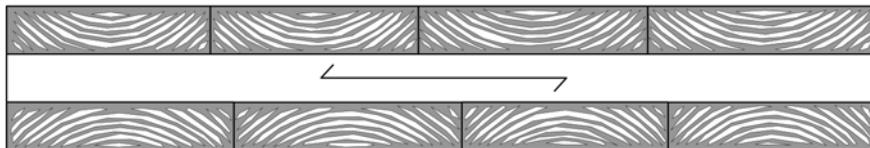
**Bild 3:** Grundsätzlicher Aufbau eines 5-lagigen Brettspertholzes
