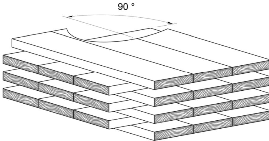
**Bild 2:** Grundsätzlicher Aufbau eines 3-lagigen Brettspertholzes
