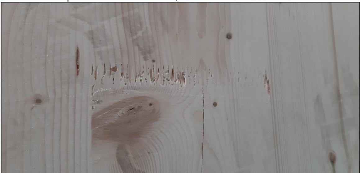
Abbildung 1: Ausbrüche einer Keilzinkenverbindung und anliegender Riss am Probekörper 1
