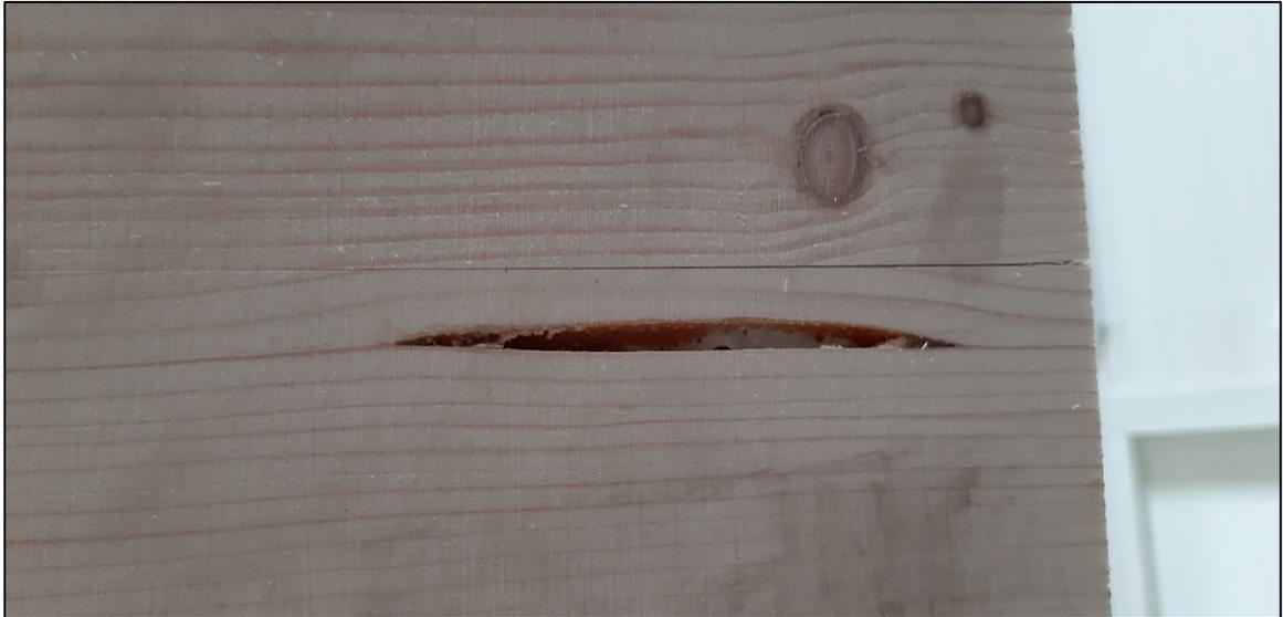
Abbildung 2: Harzgalle am Probekörper 1
