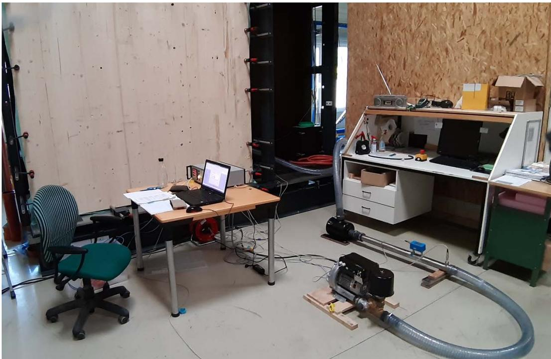
Abbildung 6: Eingespannter Probekörper 2 am Fensterprüfstand (links) der Holzforschung Austria mit angeschlossenen Laminar Master Flow-System (LMF - rechts)
