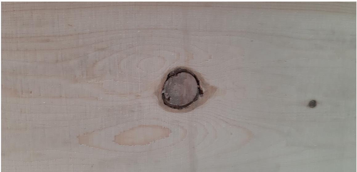
Abbildung 3: Ast am Probekörper 1
