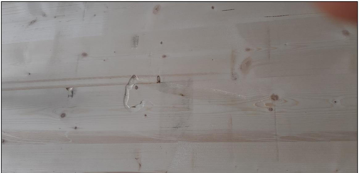
Abbildung 5: Unebenheiten/Druckstellen am Probekörper 2
