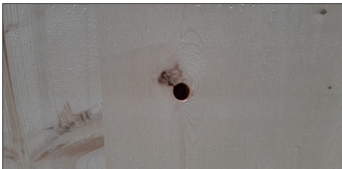
Figura 4: Foro di ramo sul campione di prova 2
