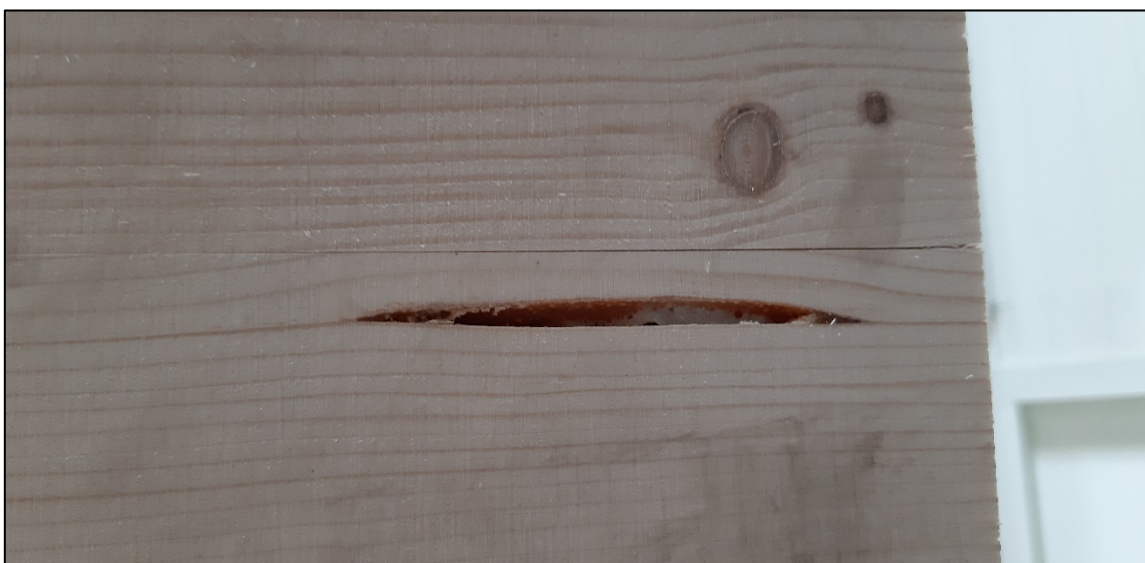
Figura 2: Galla di resina sul campione di prova 1
