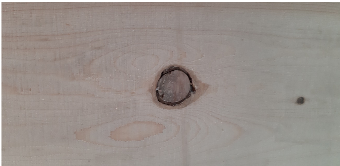
Figura 3: Ramo sul campione di prova 1
