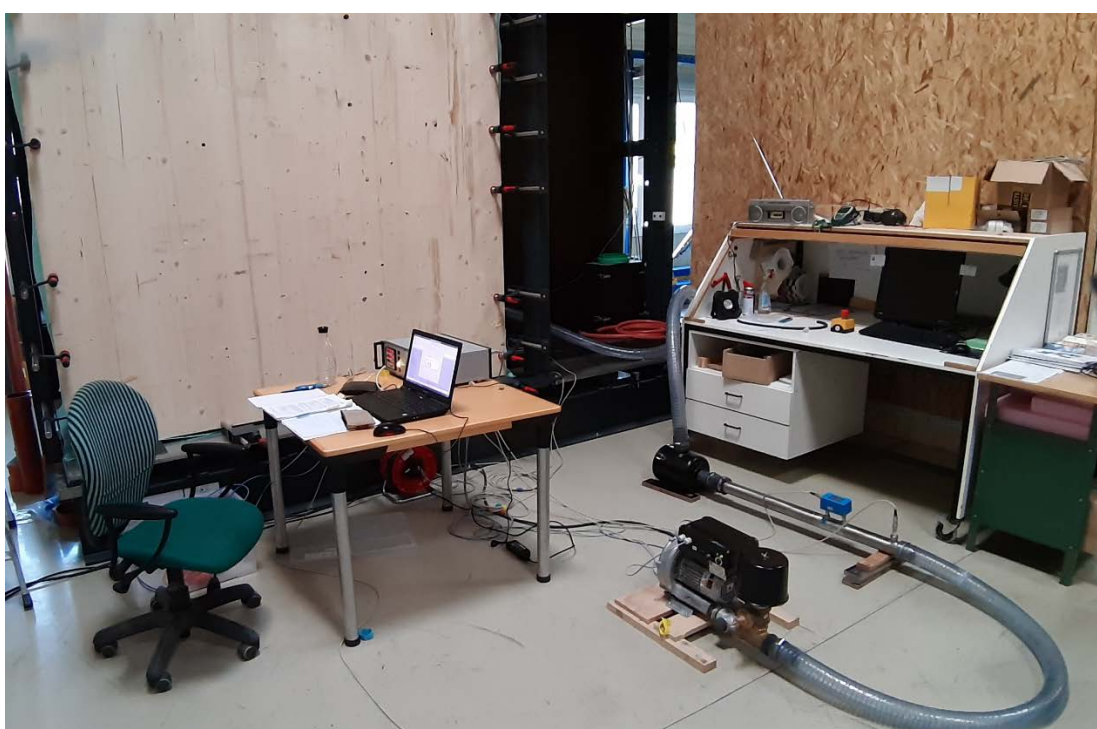
Figura 6: Campione di prova 2 fissato sul banco di prova per finestre (a sinistra) di Holzforschung Austria con il sistema Laminar Master Flow (LMF - a destra) collegato.
